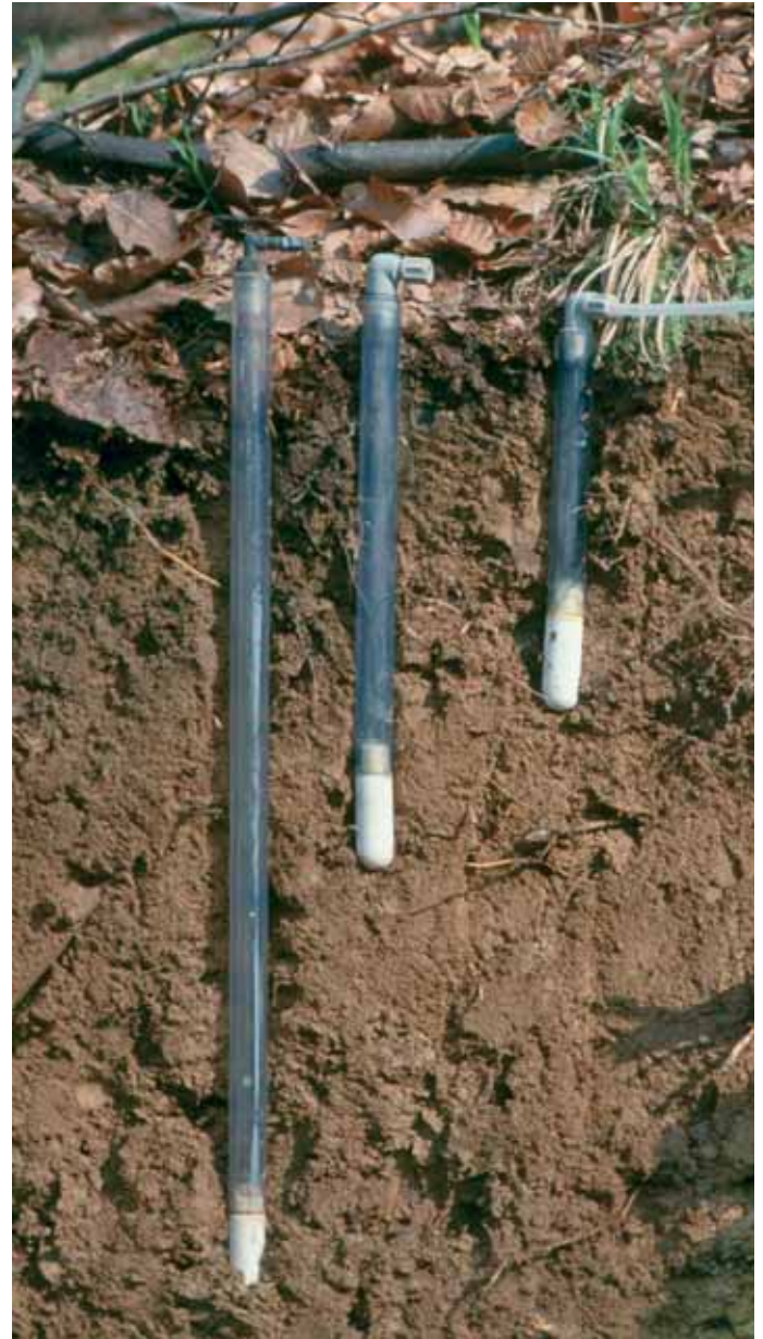
Saugkerzen zur Gewinnung von Bodenlösung in verschiedenen Tiefen Foto: NW-FVA
