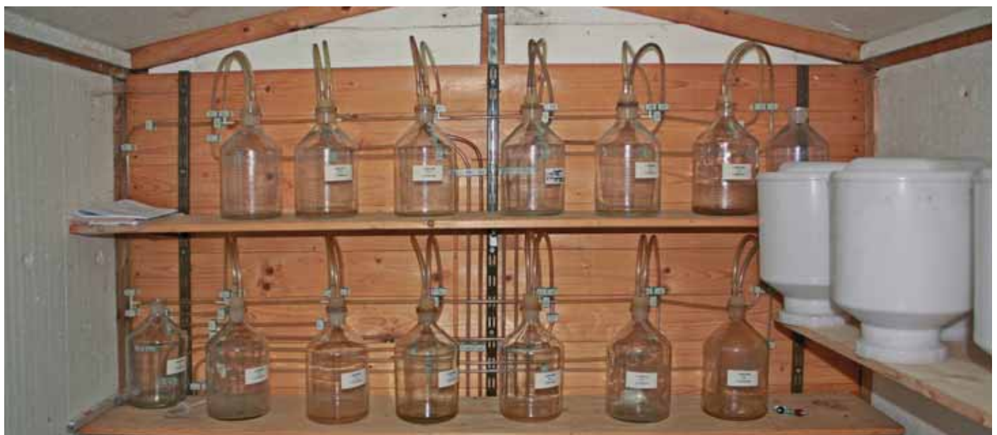
Mit Unterdruck wird Bodenlösung aus verschiedenen Tiefen gewonnen
